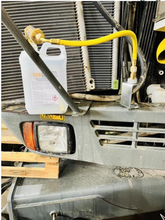
bis zum Kompressor Eingang, (Dickere Leitung mit „S“ gekennzeichnet in einem Schritt gespült werden.
